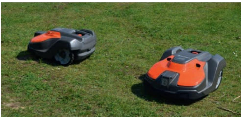
werden. Der Sendemast ist so aufgestellt, dass die beiden Mähroboter auf dem ganzen Platz ihre Signale per Satellit empfangen können. So ist es möglich, dass die Randstreifen auch gepflegt werden können. Durch den regelmäßigen Rasenschnitt, der jeden Tag stattfinden wird, wird die Rasenfläche auch gleich gemulcht
