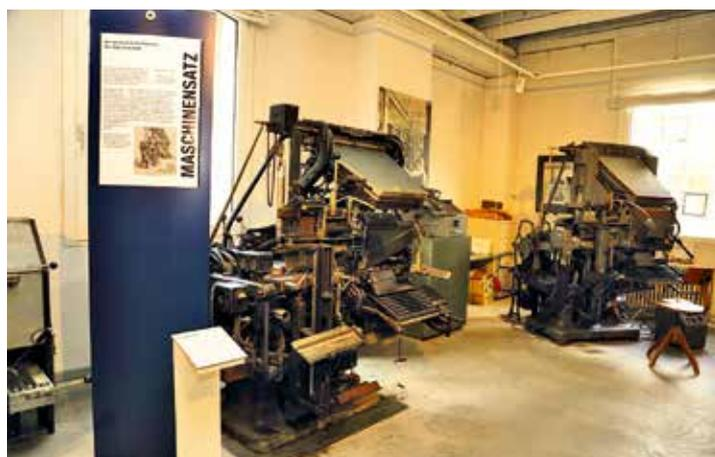
Mit der Linotype erhielt der Maschinensatz Einzug in die Setzereien. Während ein Setzer ca. 1.500 Buchstaben in einer Stunde setzte, schaffte die Linotype bis zu 6.000 Buchstaben in der Stunde.
