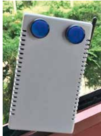
In der Ausbildungswerkstatt modifiziert: Luftgütesensor mit LED. Foto: HanseWerk AG
